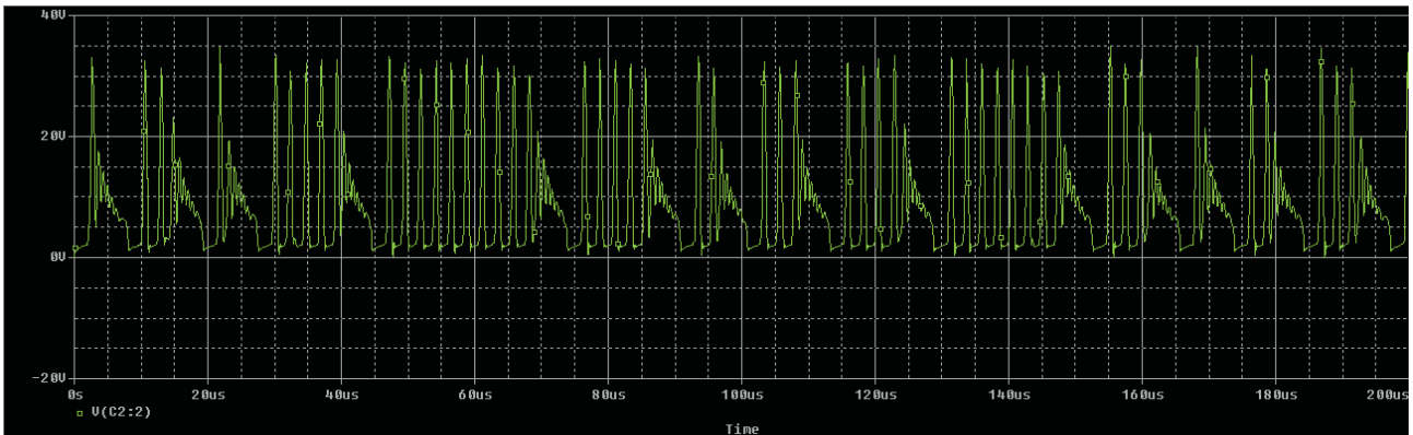
Рис. 9. Осцилограми коливань напруги на конденсаторі C2
